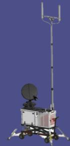
Relais véhiculaires (en option) permettant d'amplifier la couverture réseau
